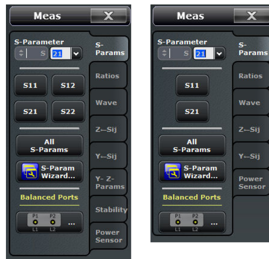
左 = R&S ZNC またはフル 2 ポート測定 R&S ZND 右 = 伝送/反射測定 R&S ZND
