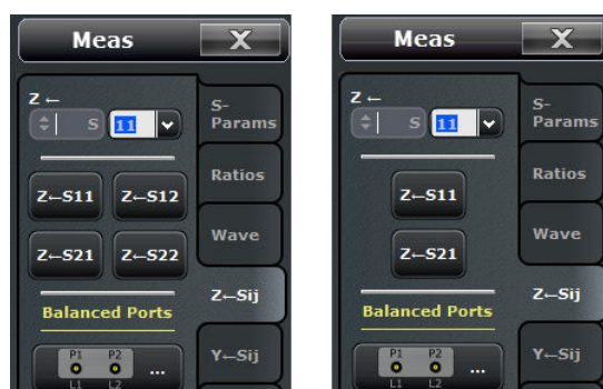
左 = R&S ZNC またはフル 2 ポート測定 R&S ZND 右 = 伝送/反射測定 R&S ZND
