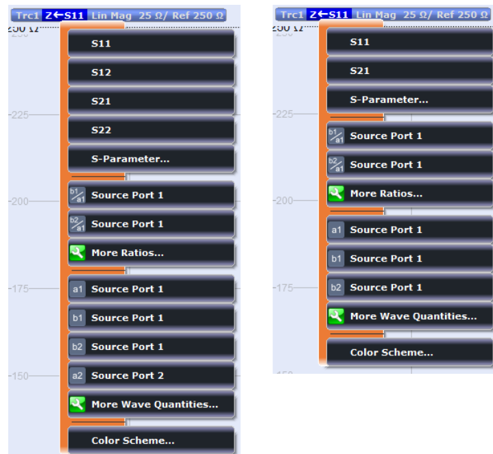
左 = R&S ZNC またはフル 2 ポート測定 R&S ZND 右 = 伝送/反射測定 R&S ZND
